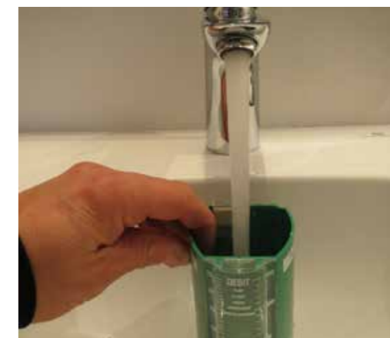
Sopra, Casale del Lago, Certificato CasaClima R, progetto Ing. Sergio Pesaresi A sinistra, impatto idrico, misurazione dell'efficienza delle installazioni idrauliche
